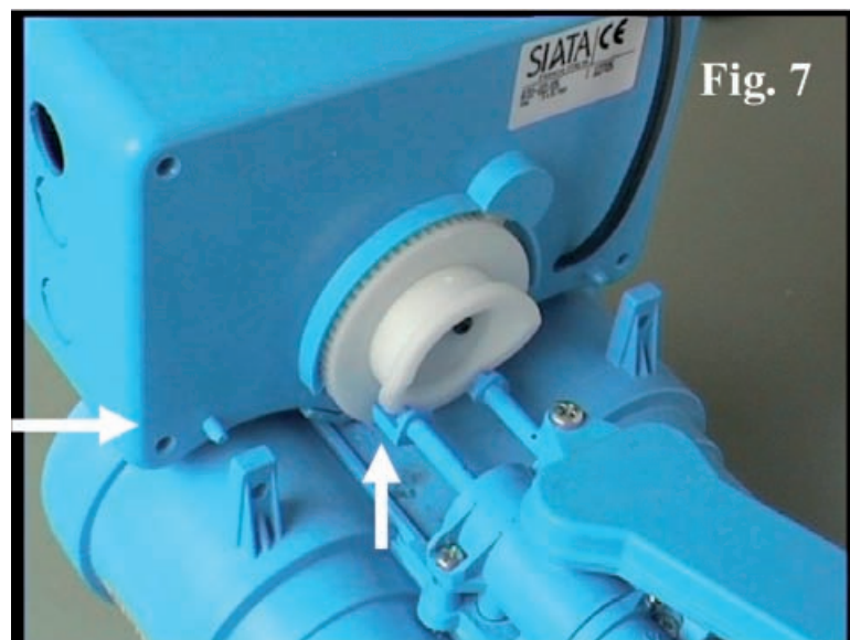
Fig. 7 – En el extremo de los pistones de los pilotos hay una parte plana con dos flechas. Colocar el borde de la leva en el espacio entre ambas flechas. Asegurarse que los pistones se han colocado hacia delante para facilitar la colocación del borde de la leva.
